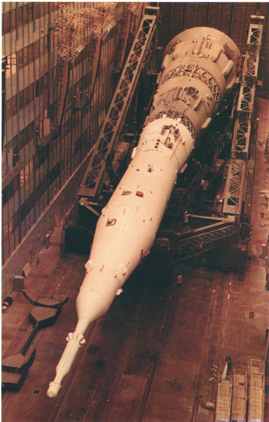
Ракета Н-1 собрана. Укладка ракеты на транспортно- установочный агрегат
